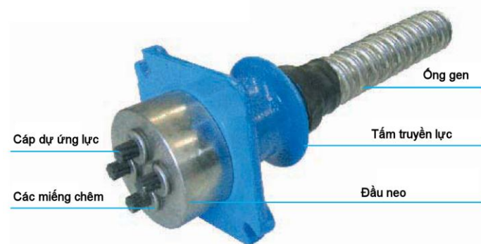
Hình 2.3 Cấu tạo một neo điển hình của VSL
