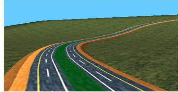
A. Hai đường cong nằm cùng chiều có đoạn chêm ngắn.
