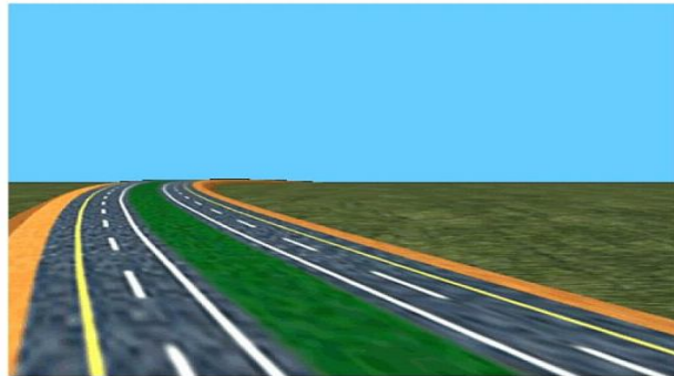
Hình 9. Sự phối hợp tốt giữa đường cong đứng lồi và đường cong nằm
