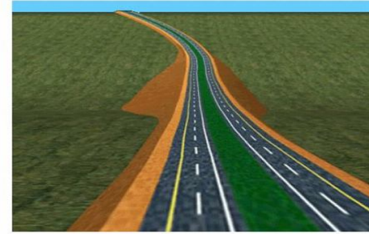
B. Đường cong đứng lõm có chiều dài lớn nối tiếp vào đường cong bằng
