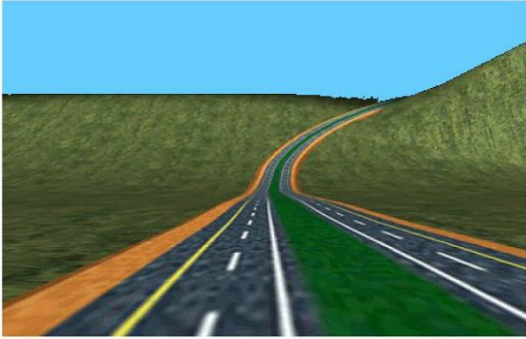
Hình 6. Sự phối hợp không tốt giữa đường cong đứng và đường cong nằm.
