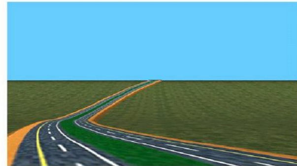
Hình 10. sự phối hợp tốt giữa đường cong đứng lõm và đường cong bằng
