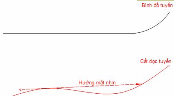
Hình 8. Tuyến đường trông như bị gãy khúc
