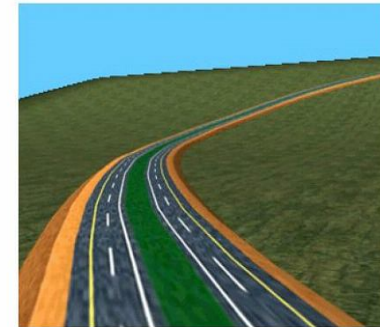
B. Thay thế hai đường cong bằng cùng chiều có đoạn chêm ngắn bằng một đường cong lớn
