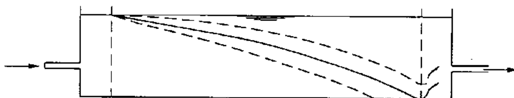
Hình 6.25a. Ảnh hưởng xấu của dòng chảy rối đến hiệu quả lắng khi lắng hạt cặn tự do
