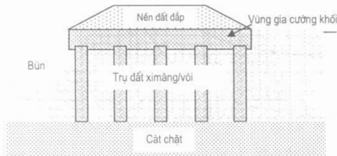
Hình 6.1. Sơ đồ cải tạo khối và trụ kết hợp.
