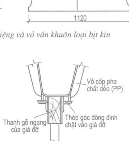
**Hình 1.69. Phương pháp ghép dựng vỏ ván khuôn chất dẻo đơn hướng**
