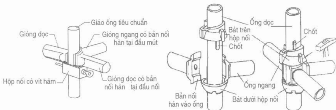
Hình 2.50. Chi tiết liên kết khung thép ống tiêu chuẩn
