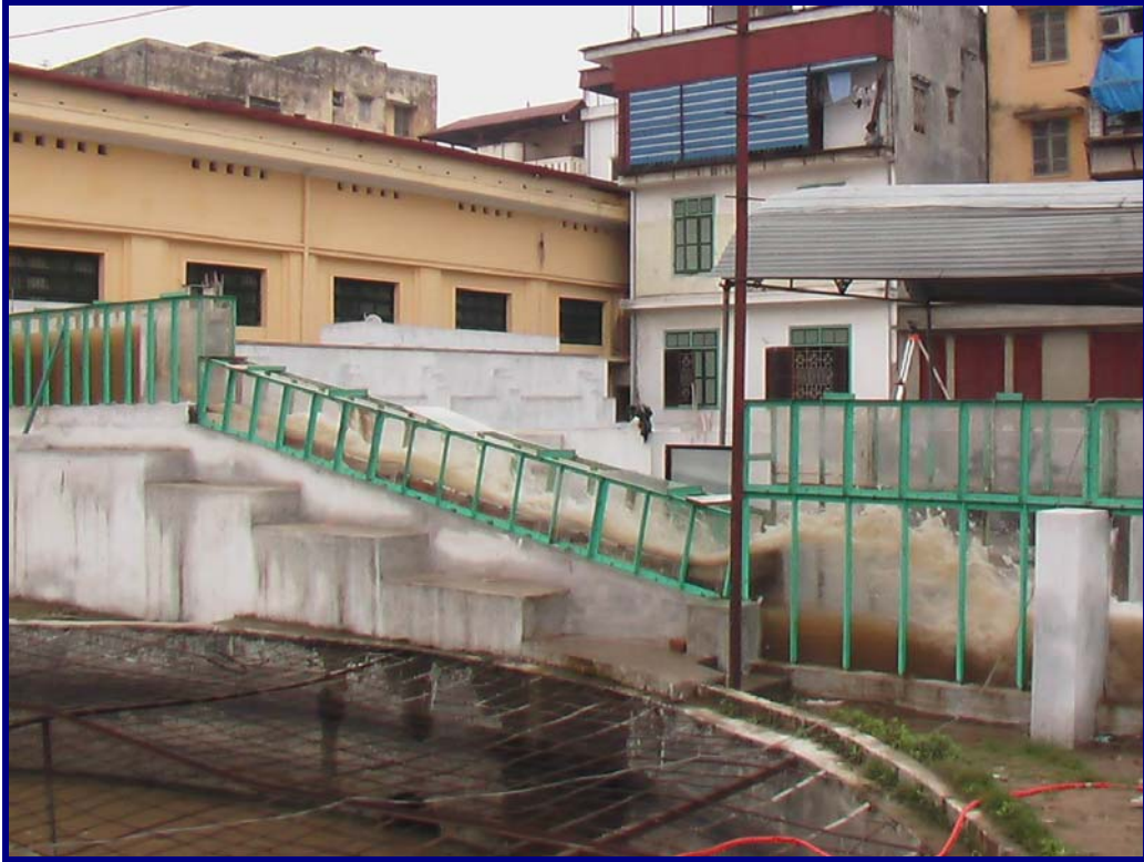
Ảnh 2.1. Mô hình mặt cắt - có TBTK trên dốc nước
