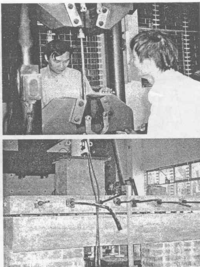
Hình 4.33: Kiểm tra chất lượng thép và cấu kiện ứng lực trước tại phòng thí nghiệm
