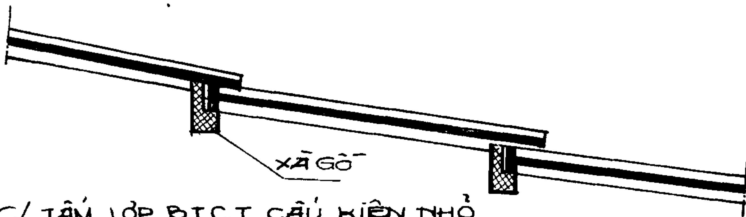
MÁI PHÂN CÁCH BẰNG B.T.C.T LẮP GHÉP LOẠI MÁI DỐC VÀ MÁI BẰNG
