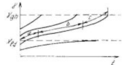
Hình 4-8. Sự phụ thuộc của đặc điểm từ biến của đất vào thời gian với những tải trọng khác nhau
