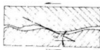
Hình 4-3. Hình thái mặt tiếp xúc nhám
