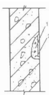
Hình 10.46. Hoàn thiện sửa chữa tổ ong bằng bê tông
