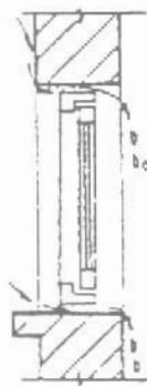
Hình 10.21. Nước thấm xung quanh khung cửa sổ
