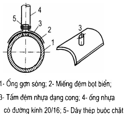
Hình 91: Chứa lỗ bơm vữa trên ống xoắn gợn sóng
