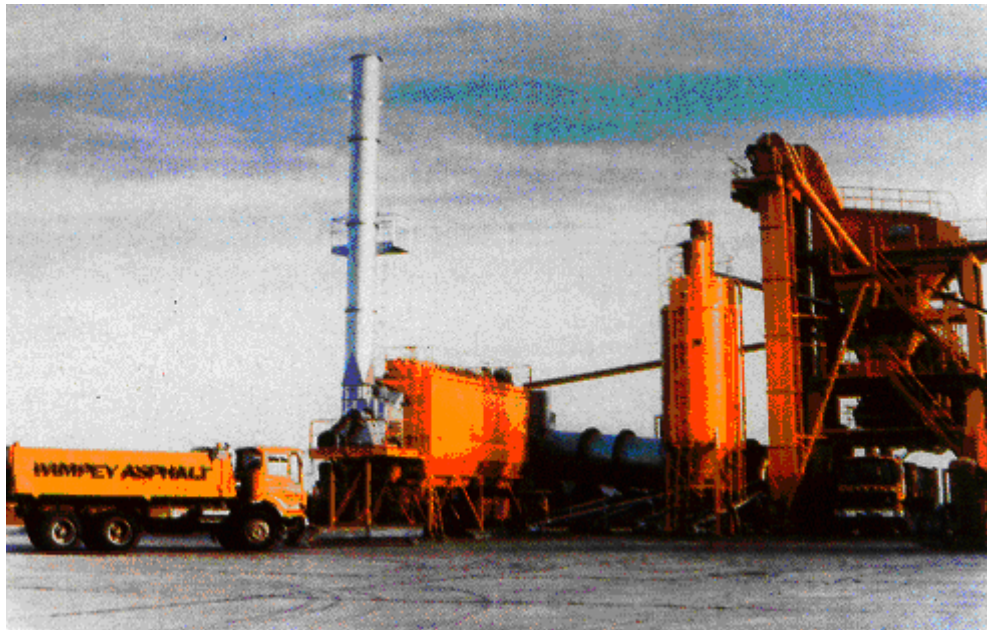
Hình 9.1. Trạm trộn chu kỳ sấy nóng gián tiếp
