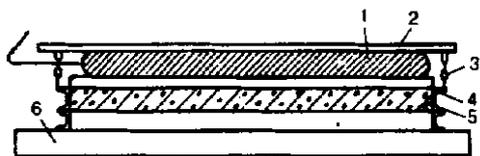
**Hình 9-4.** Sơ đồ tạo hình bằng rung - ép.
