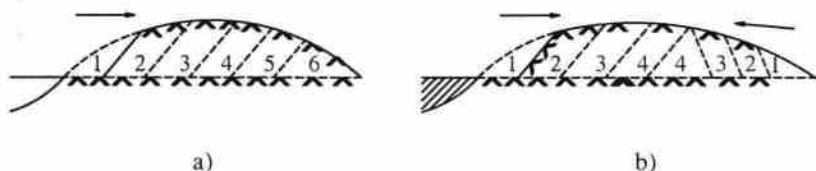
Hình 4-1: Đào nền đường theo chiều ngang.
