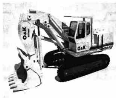
Hình 3-3: Máy đào gầu thuận.
