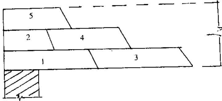
Hình 3.38. Đổ bê tông dầm có chiều cao  $> 80$ cm
