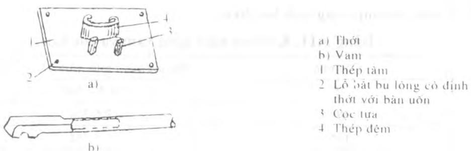
Hình 3.18. Dụng cụ uốn thép có đường kính lớn
