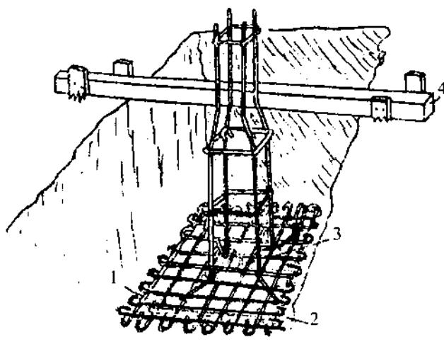
**Hình 3.30. Dụng cụ buộc cốt thép móng độc lập**
