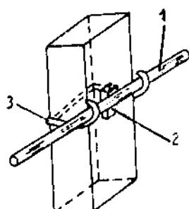
*Hình 4.29. Cách điều chỉnh cột bằng đòn ngang*
