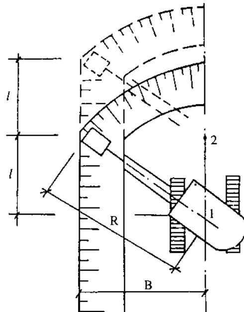
Hình 1.25 Sơ đồ phát triển hố đào và hóng di chuyển máy đào gầu thuận.
