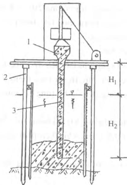
**Hình 3.39. Đổ bê tông theo phương pháp ống dẫn**
