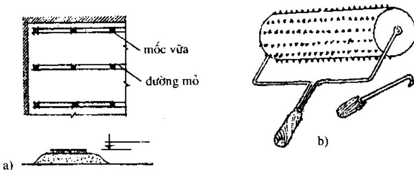
**Hình (5.10) Mở móc vữa, quả bu sắc lăn gai và cò kẻ mạch**
