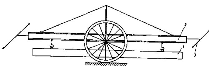
**Hình 4.21** Xe cải tiến chuyên dùng.
