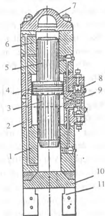
Hình 1.53 Búa hơi nước tác dụng kép
