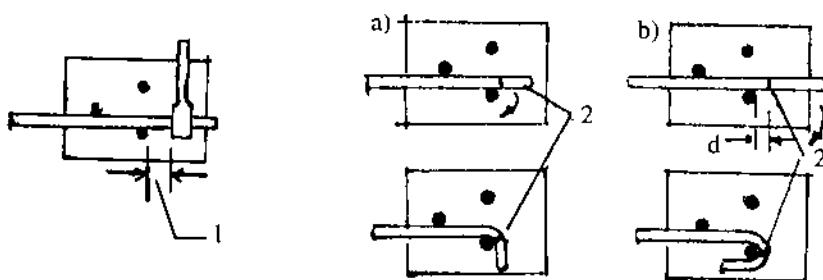
**Hình 3.19.** Quan hệ giữa khoảng cách của vam với cọc tựa và vạch dấu điểm uốn
