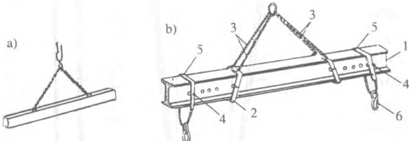
Hình 4.31. Treo buộc dầm bê tông cốt thép.
