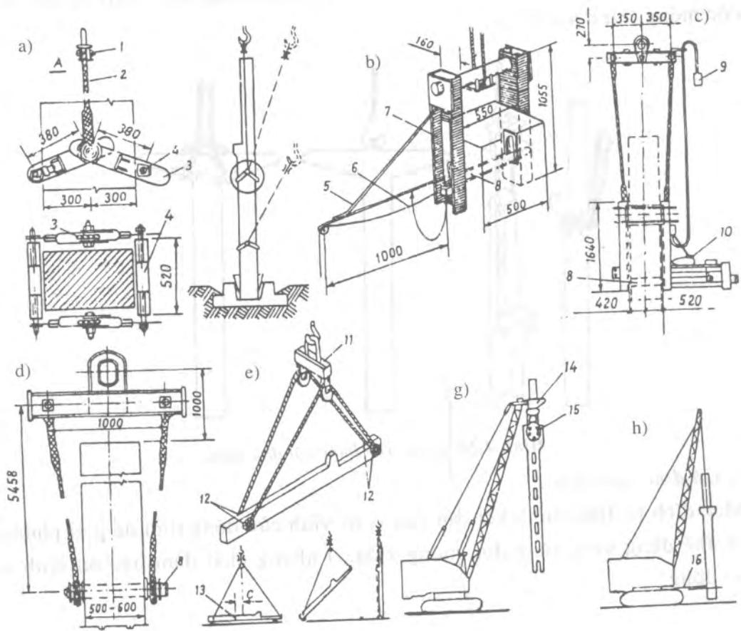
Hình 4.26. Các cách treo buộc cột bằng các dụng cụ chuyên dùng
