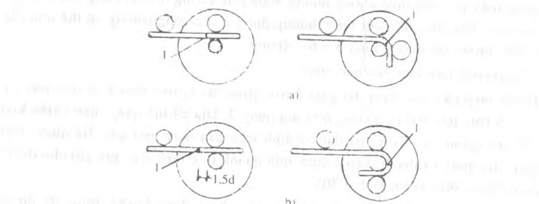
Hình 3.21. Quan hệ giữa vách dẫu điểm uốn và trục tam
