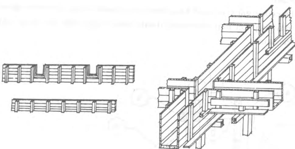
**Hình 3.9.** Ván khuôn dầm chính với dầm phụ
