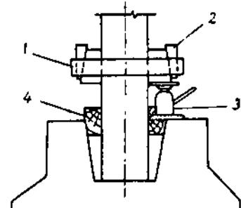
*Hình 4.30 Cách điều chỉnh cột bằng kích*
