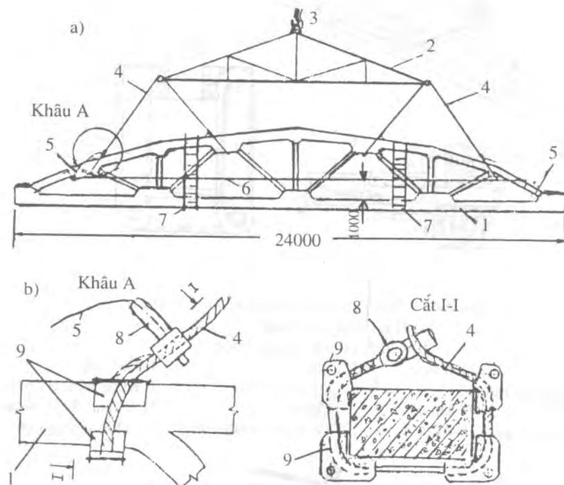
Hình 4.36. Treo buộc dàn bằng bốn dây cẩu có khóa bán tự động
