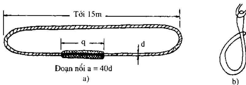
**Hình 4.1. Dây cáp kép**
