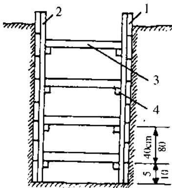
Hình 1.21a. Chống đỡ sát lở bằng ván ngang đối với hố móng hẹp văng 2 mặt vách đất
