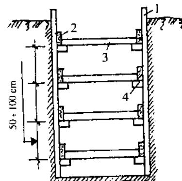
Hình 2.21d. Chống đỡ thành đất bằng ván dọc
