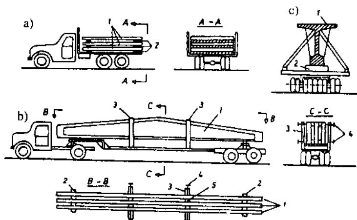
**Hình 4.20** Vận chuyển cấu kiện bằng ô tô.
