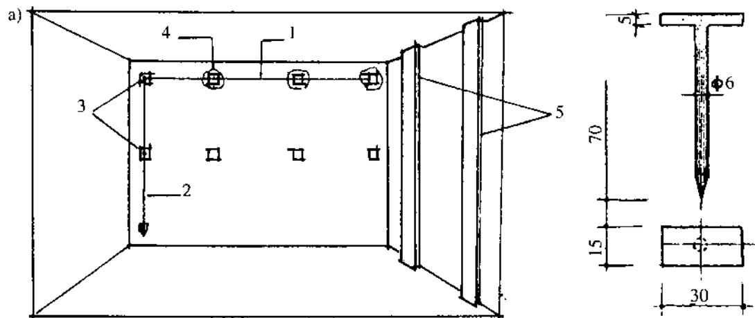
1. Dây căng ngang; 2. Dây dọi; 3. Đinh; 4. Mõc vữa; 5. Dải mõc vữa thẳng đứng
