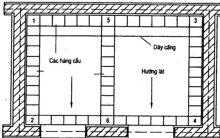
**Hình 12.22. Làm móng và lát nền.**
