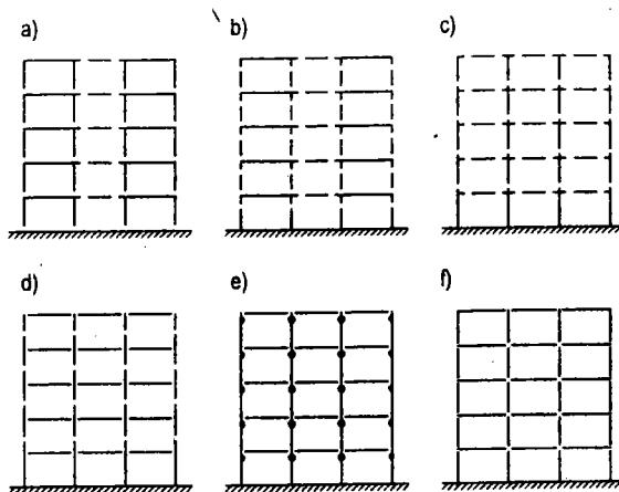
**Hình 1.4. Các sơ đồ phân cắt bộ khung nhà công nghiệp
