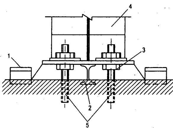
Hình 6.1. Chuẩn bị mặt móng cột có xóng tựa.
