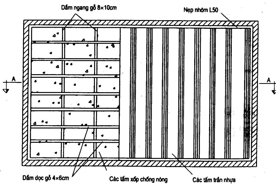
*Hình 12.47. Mặt bằng trần nhựa.*
