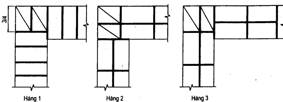
**Hình 11.4. Cấu tạo tường 220**
