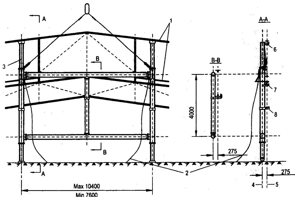
Hình 6.16. Đòn treo để lật đứng và cẩu lắp các dàn vì kèo thép có cả khung cửa trời.
