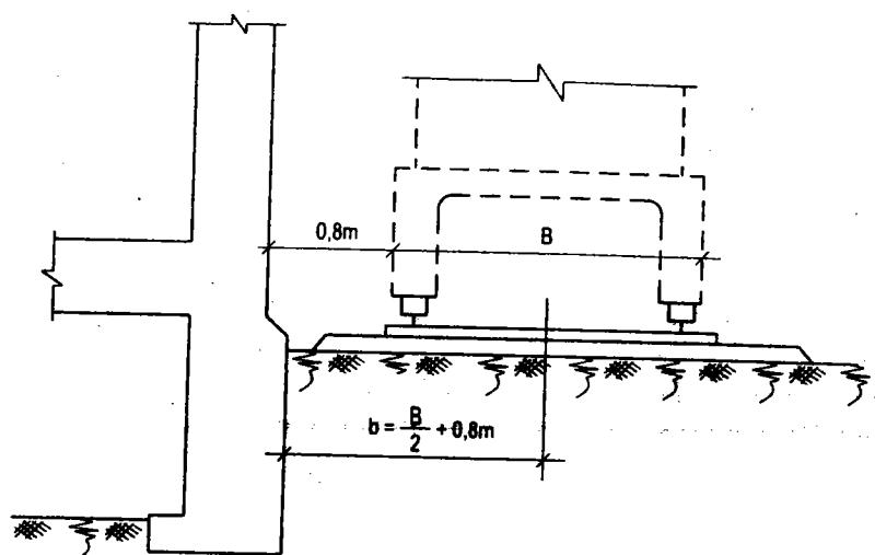
*Hình 2.23. Bố trí cẩu trục tháp khi hố móng đã lấp*
