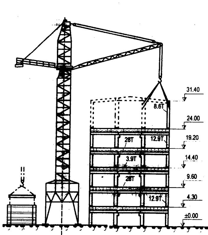
**Hình 8.11.** Lắp ghép nhà công nghiệp nhiều tầng có kết cấu khung cứng, bằng cần trục tháp
