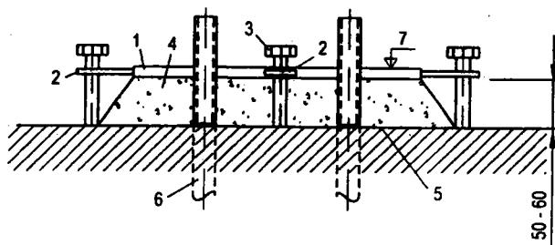
**Hình 6.2. Móng cột thép có tấm đế cột chôn sǎn.**
