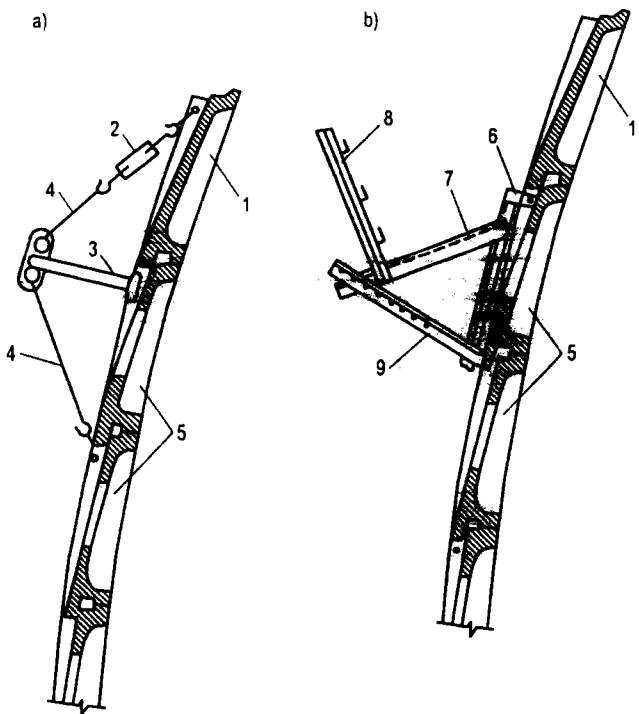
**Hình 9.1. Cấu tạo mái vòm cầu làm bằng các tấm bê tông cốt thép đúc sẵn;**
