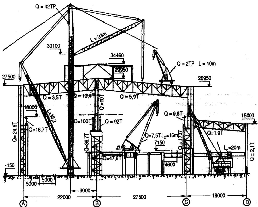
Hình 8.8. Lắp ghép phần xương luyễn thép bằng cần trực trụ dây giằng
