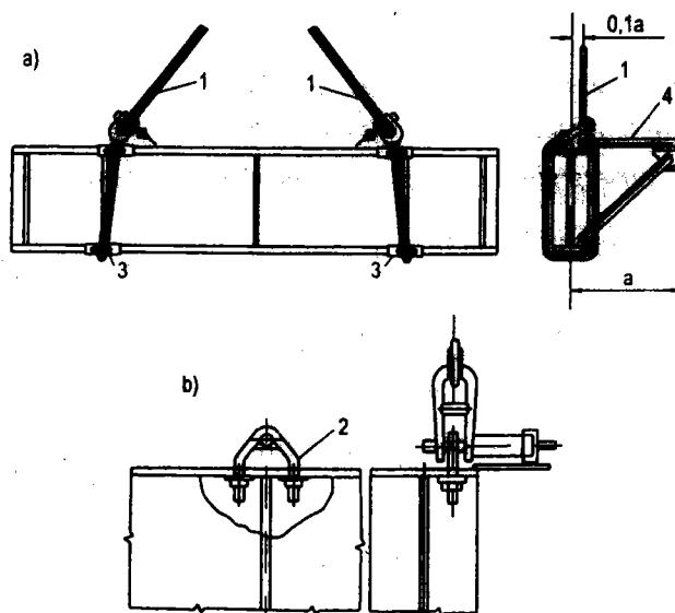
**Hình 6.10. Treo buộc dầm cầu chạy bằng dây cầu có khóa bán tự động.**
