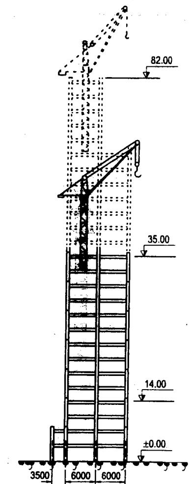
**Hình 8.12.** Lắp ghép khung nhà thép của một phân xưởng hóa chất nhiều tầng bằng cần trục leo
