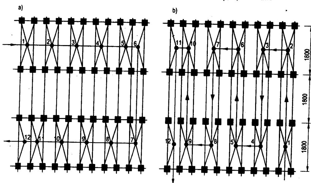
**Hình 8.4. Đoạn đường di chuyển của cần trục tự hành khi lắp thép cột**
