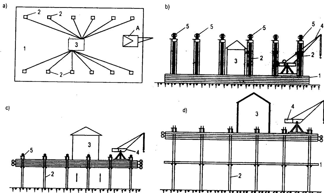
**Hình 7.7. Trình tự lắp ghép nâng sàn**
