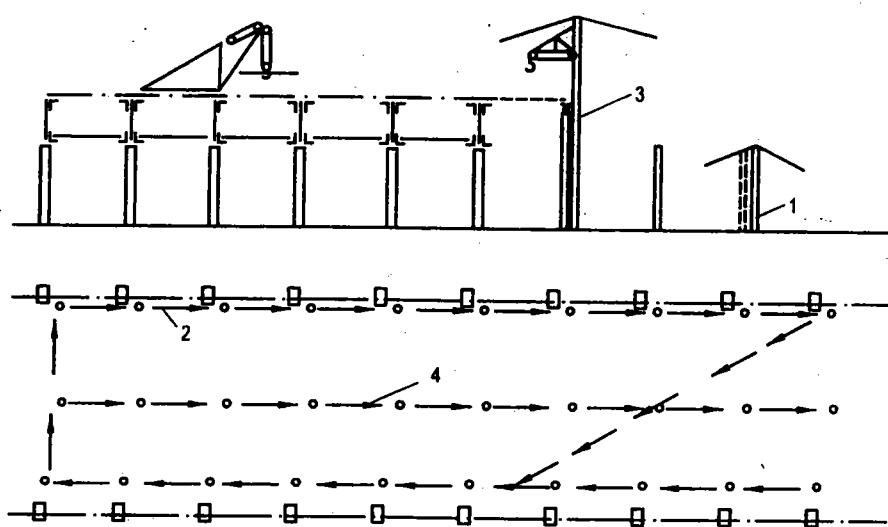
**Hình 8.6. Lắp ghép khung nhà công nghiệp bằng các cột trụ cầu lắp.**
