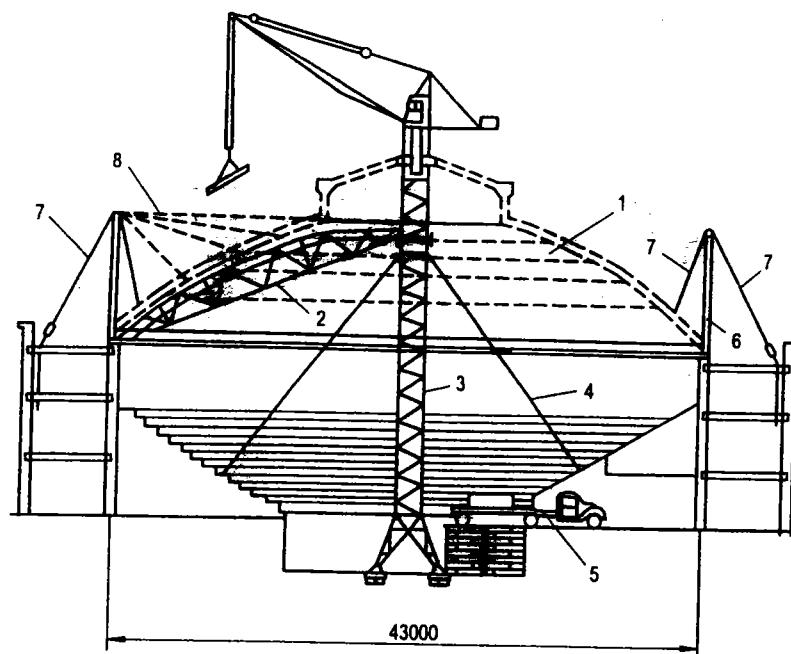
**Hình 9.2. Lắp vòm mái ráp xiéc bằng một khuôn mẫu dàn thép di động**
