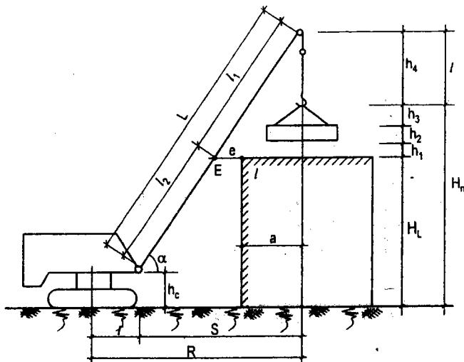
Hình 2.19. Sơ đồ tính thông số khi cần trục lắp ghép kết cấu có lát cần phía trước
