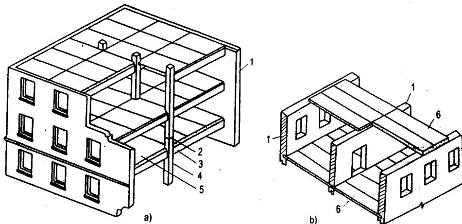
**Hình 1.1. Nhà xây gạch nửa lắp ghép:**
