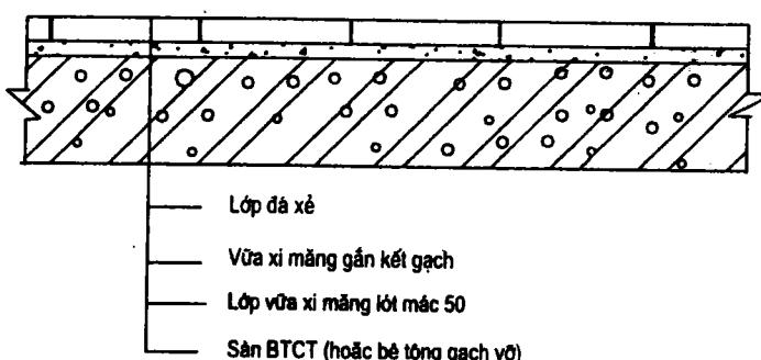
*Hình 12.23. Cấu tạo nền lát đá xé.*
