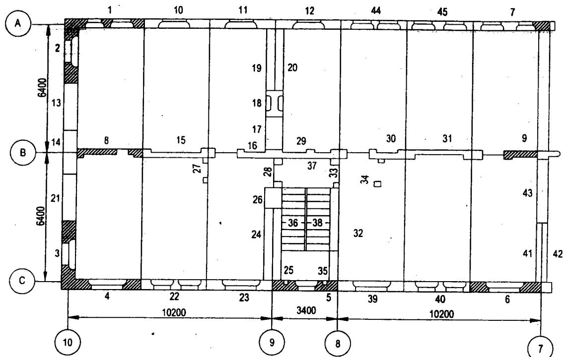
**Hình 7.4. Trình tự lắp ghép nhà panen có đặt trước các panen cũ.**
