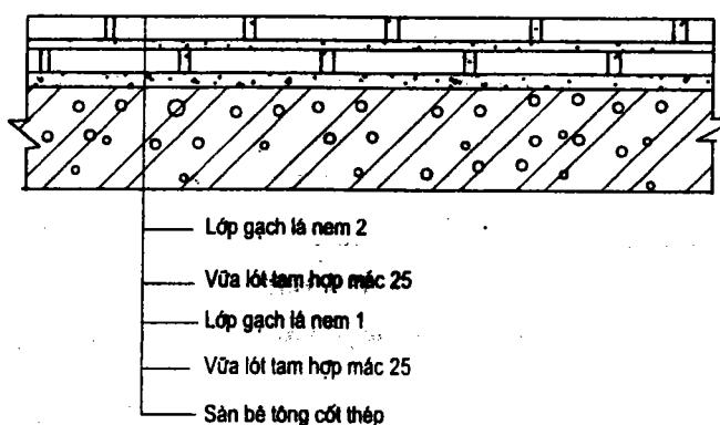
Hình 12.18. Cấu tạo nền lát gạch lá nem.
