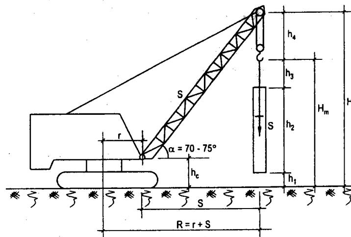
**Hình 2.18. Sơ đồ tính thông số khi cẩu trục lắp ghép kết cấu không có vật cản phía trước**
