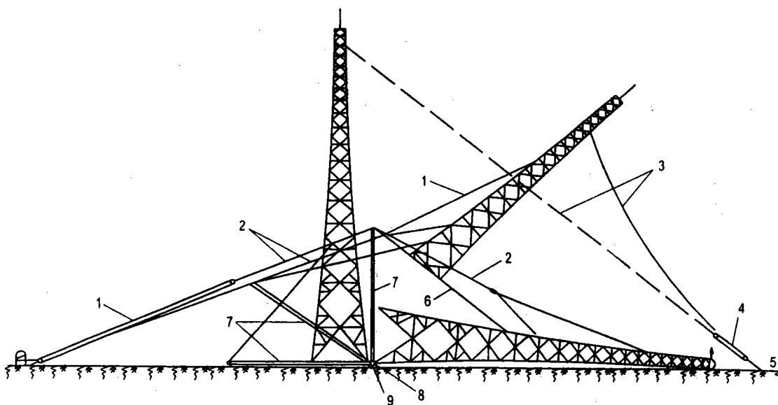
*Hình 10.2. Dụng tháp bằng cách quay*
