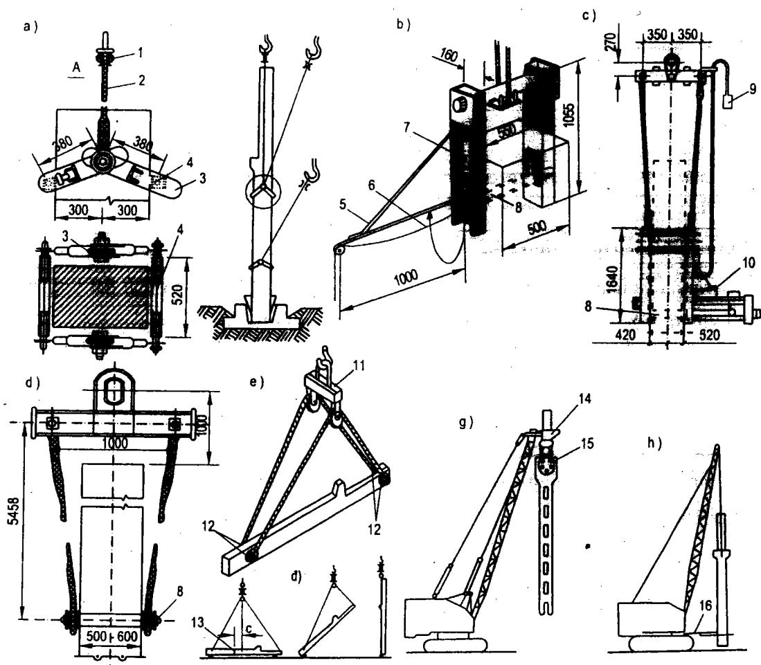
**Hình 4.1b. Cách treo buộc cột bằng các dụng cụ chuyên dùng:**
