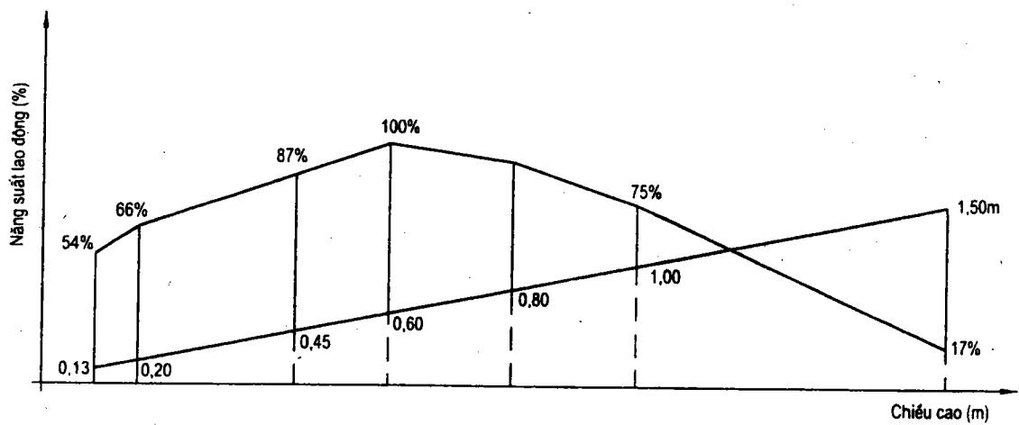
**Hình 11.11. Quan hệ chiều cao xây và năng suất xây**
