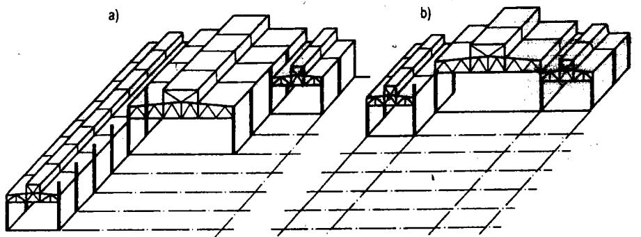
**Hình 8.2. Sơ đồ lắp ghép nhà công nghiệp**
