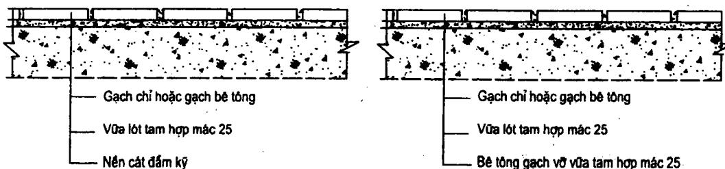
**Hình 12.14. Cấu tạo các loại nền lát gạch dày.**
