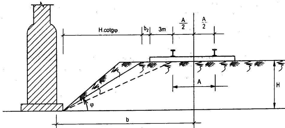
**Hình 2.22. Bố trí cần trục tháp khi hố móng chưa lấp đất**
