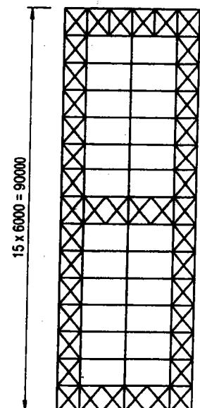
**Hình 1.7. Sơ đồ bố trí các hệ giằng giữa các dàn vị kèo thép**
