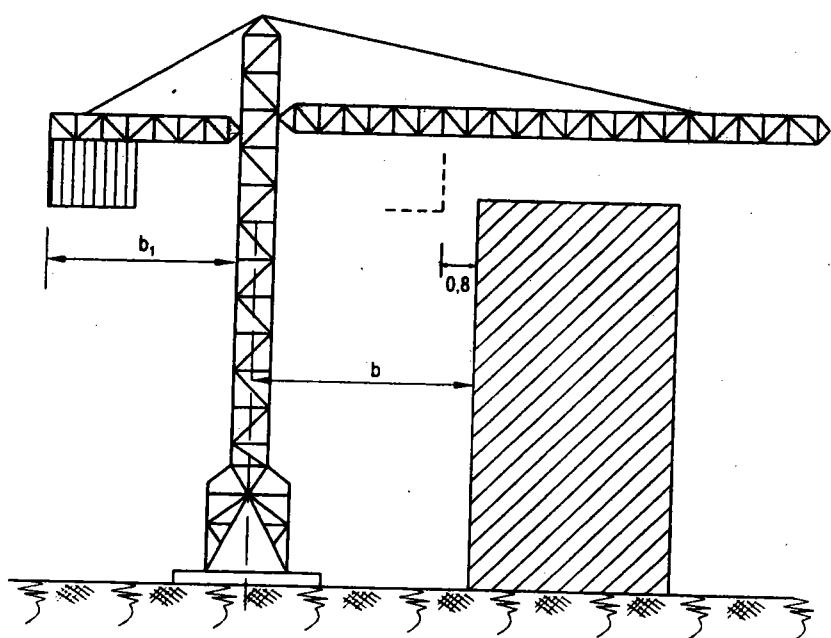
*Hình 2.24. Bố trí cẩu trục tháp có đối trọng ở trên cao nhưng vẫn thấp hơn công trình*
