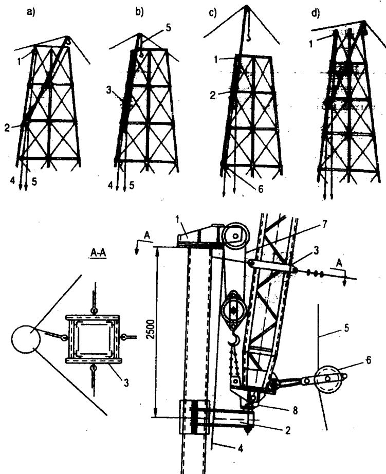
*Hình 10.3. Lắp ráp tháp theo cách chắp nối dần trên cao bằng đòn cầu*
