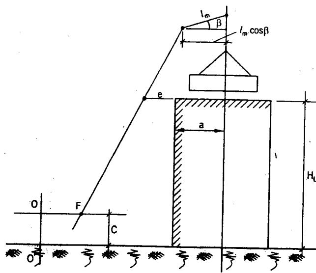
**Hình 2.20.** Sơ đồ tính thông số khi cần trục lắp ghép kết cấu có vật cản phía trước có mỏ phu.
