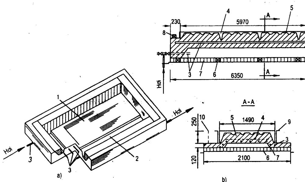
Hình 3.3. Sàn in bê tông cốt thép
