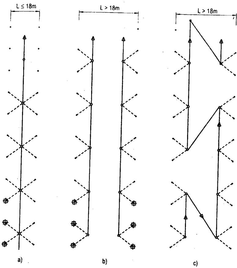
**Hình 8.3. Sơ đồ di chuyển của cầu trục khi lắp ghép cột, dầm cầu chạy và nhà công nghiệp một tầng**
