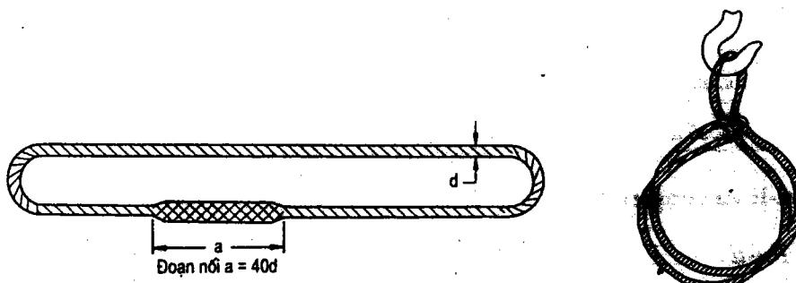
**Hình 2.2. Dây cáp kép**
