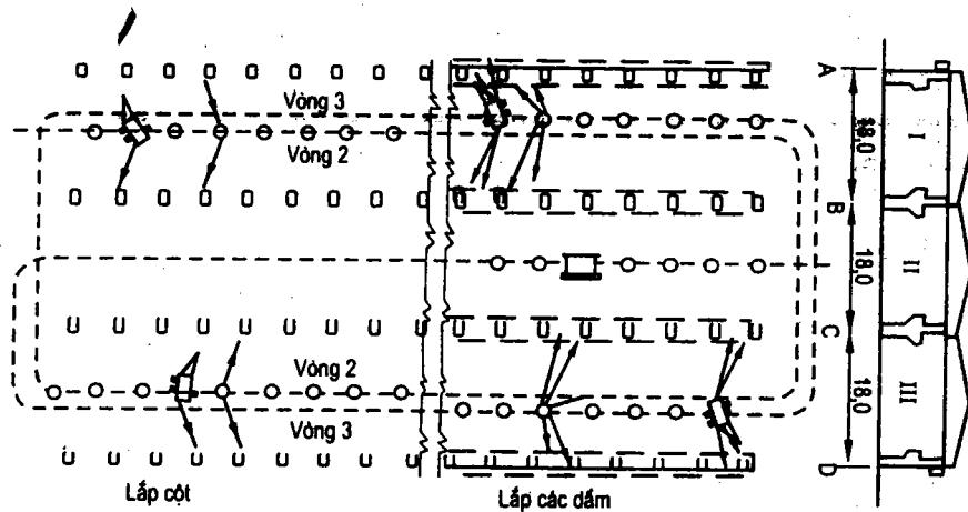
**Hình 8.5. Sơ đồ di chuyển của cần trục bánh xích khi lắp nhà công nghiệp ba khâu độ**
