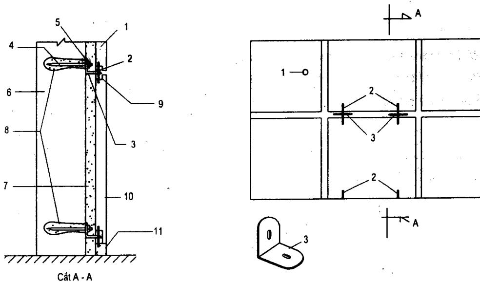
**Hình 12.38. Liên kết tấm ốp vào tường công trình bằng lá thép.**
