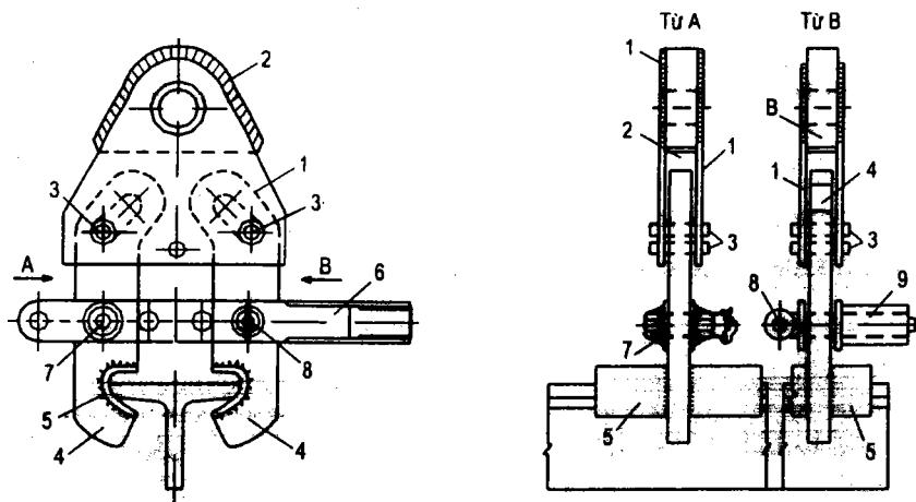
**Hình 6.9. Treo buộc dầm bằng dụng cụ riêng.**
