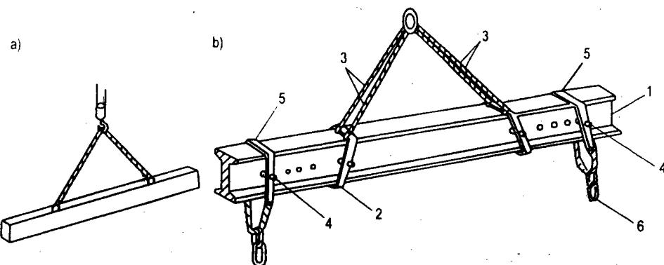
**Hình 4.8. Treo buộc dầm bê tông cốt thép**
