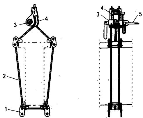
**Hình 4.10. Thiết bị treo buộc dầm BTCT có khóa bán tự động.**
