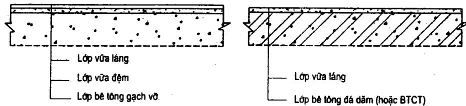
Hình 12.25. Cấu tạo nền, sàn.
