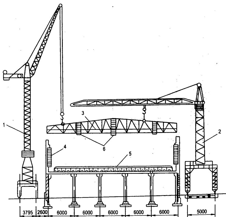
**Hình 8.10. Lắp ghép một phần xưởng bằng hai cần trục tháp**
