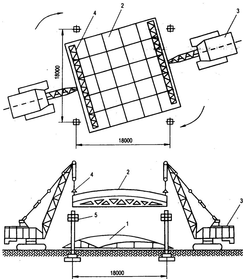
*Hình 9.3. Lắp ráp vò mỏng  $18 \times 18m$ , nặng 56 tấn*
