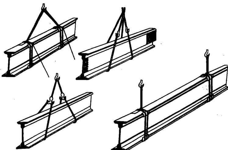
Hình 6.8. Treo buộc đàm bằng dây cầu thường
