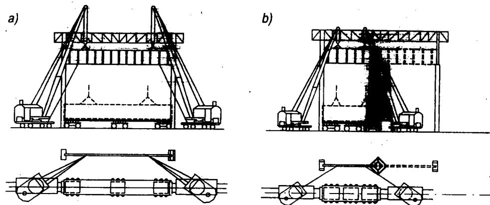
**Hình 6.11. Các biện pháp lắp ghép dầm cầu chạy nặng**
