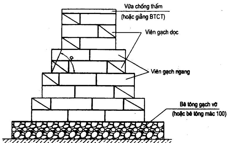
**Hình 11.3. Mặt cắt ngang móng gạch**
