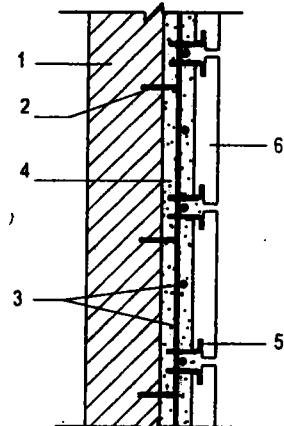
**Hình 12.37. Liên kết tấm ốp vào tường bằng móng sắt, lưới thép có chèn vữa**
