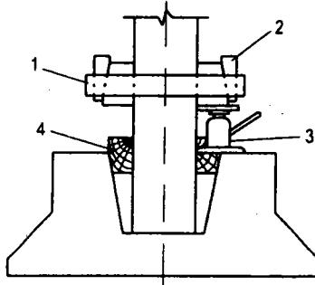
**Hình 4.5. Cách điều chỉnh cột bằng kích.**
