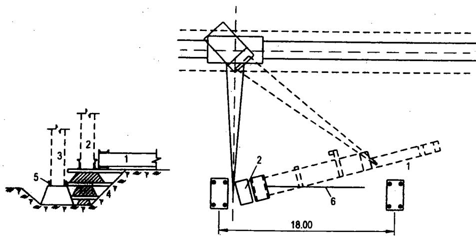
**Hình 6.6. Phương pháp quay lắp dựng cột.**
