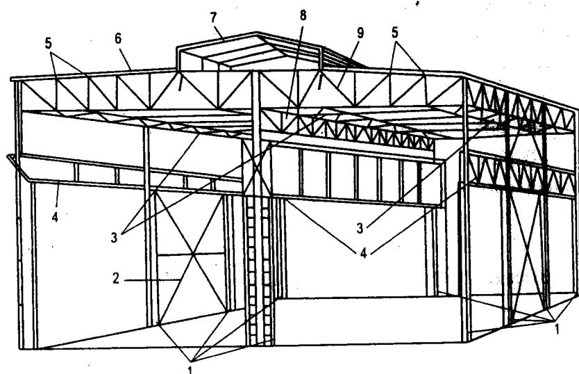
**Hình 1.5. Bộ khung nhà công nghiệp bằng thép**
