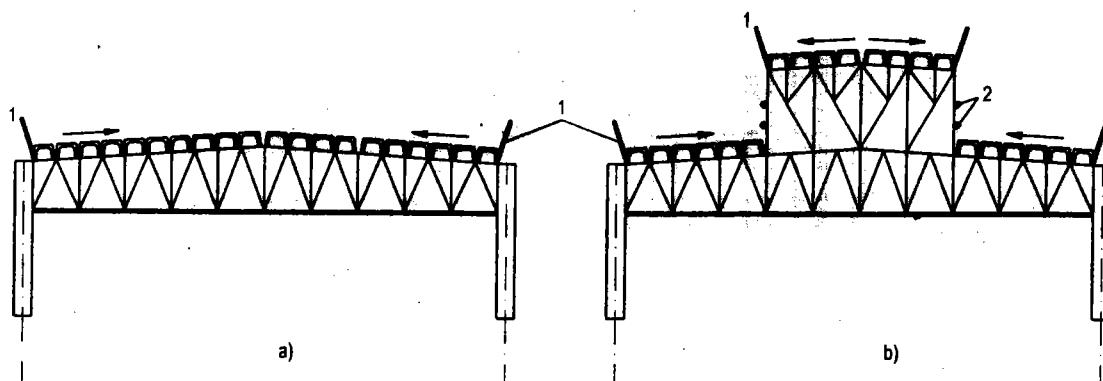
**Hình 6.18. Trình tự lắp các tấm panen mái**
