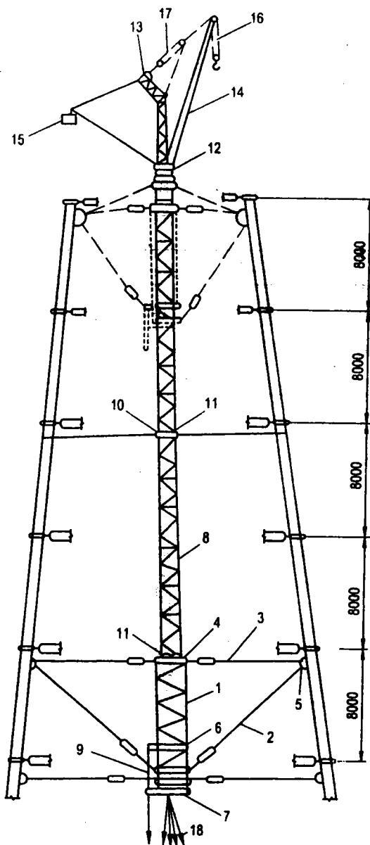
**Hình 10.7. Cầu trục treo để lắp ráp tháp**
