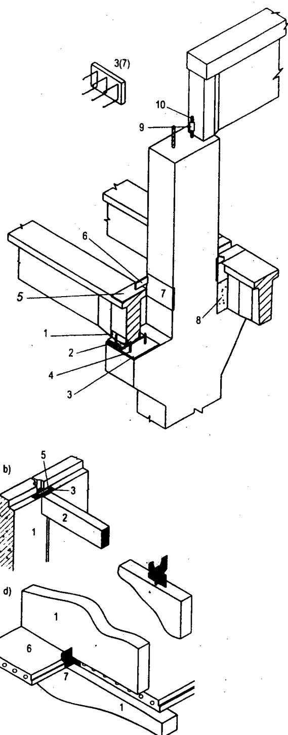
**Hình 3.7. Các mối nối tấm tường với dầm và với panen sàn :**
