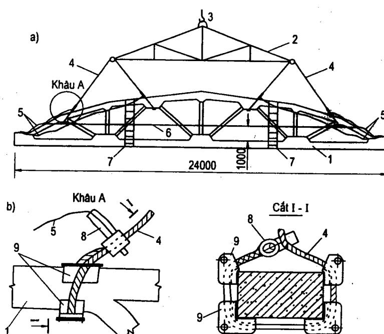
**Hình 4.14. Treo buộc dàn mái bằng bốn dây cầu có khóa bán tự động.**
