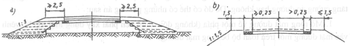
Hình 10.2. Mở rộng mặt đường cả hai phía
