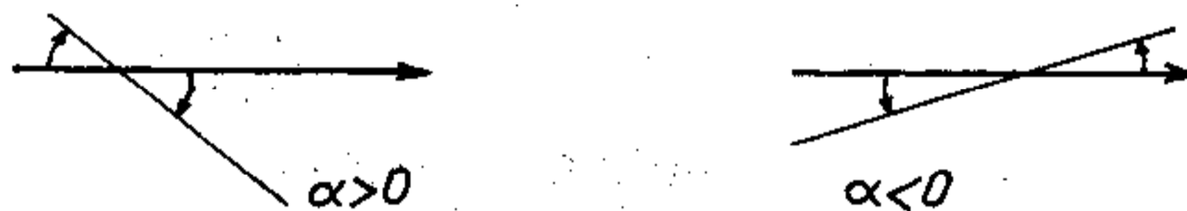
Hình 2-19. Dấu của lực cắt theo tiếp tuyến của biểu đồ mômen uốn
