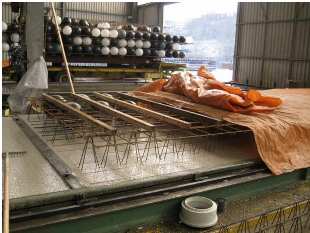
9. Phủ bạt hạn chế bốc hơi nước, có thể bơm hơi nước nóng để tăng nhanh cường độ.
