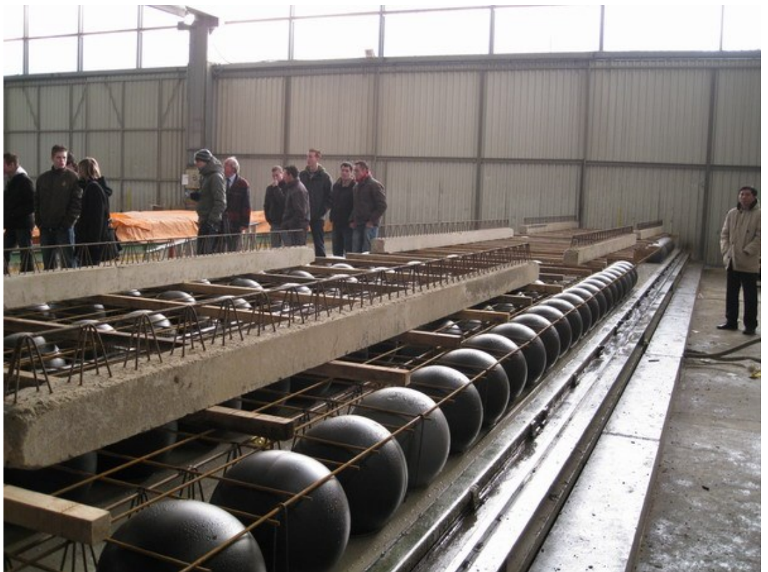
6. Chuẩn bị ván khuôn, thành ván khuôn cao khoảng 6-7cm, ván khuôn bằng thép nhấn được thổi dầu cặn dạng sương để chống dính
