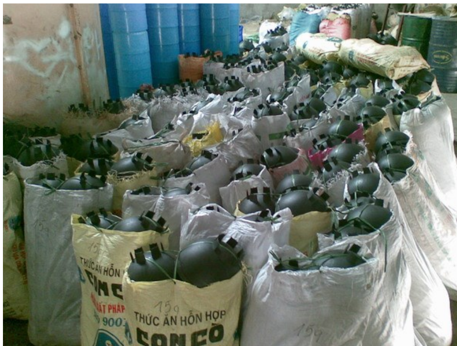
1. Đúc các nửa quả bóng bằng nhựa rỗng, loại nhựa HDPE. Vận chuyển đến công trường.
