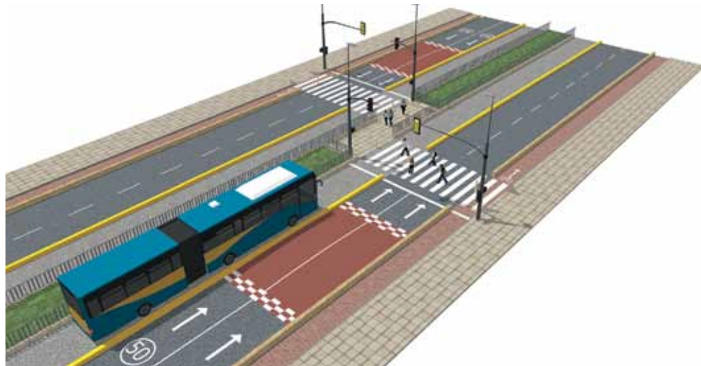
Các lối sang đường giữa phố trên trục đường chính đô thị.
