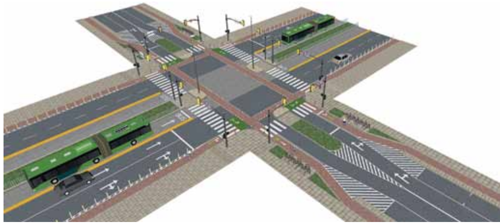
Trục đường chính với dải phân cách trung tâm, làn đường cấm rẽ trái và ưu tiên xe buýt.
