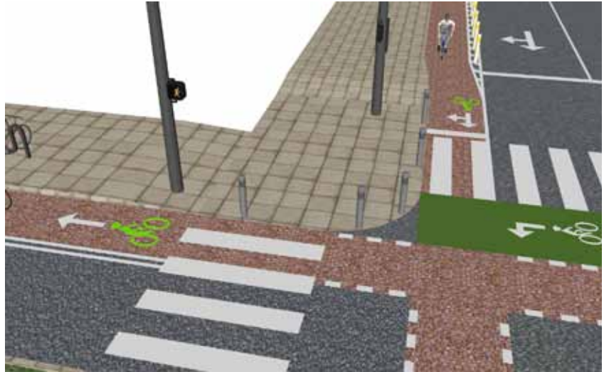
Nút giao cắt cân tăng cường tầm nhìn giữa người lái xe và người đi xe đạp khi họ đến nút giao cắt, và có ô rẽ trái theo hai bước.
